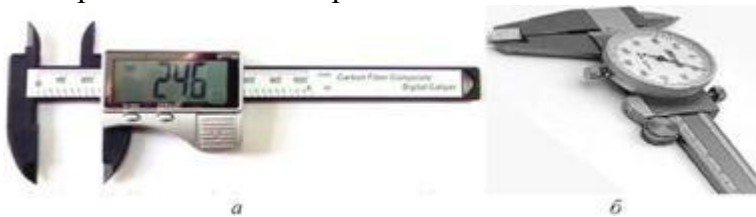
Рис. 5.6. Штангенциркуль цифровий (а), зі стрілочним індикатором (б)
