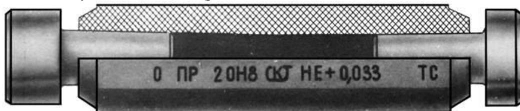
Рис. 4. Загальний вигляд та маркування двосторонньої повної калібр-пробки
