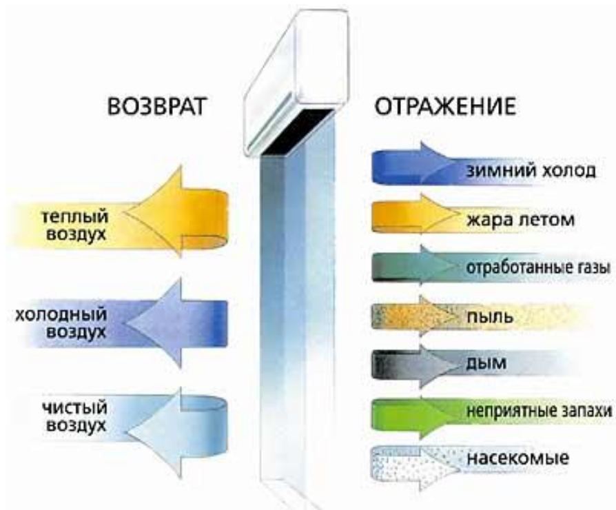
Рис. 43. Схема роботи повітряної завіси
