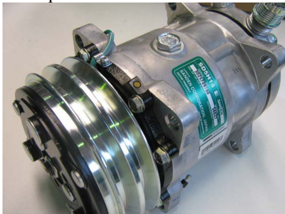
Рис. 1.9. Компресор Sanden SD5H14 (з клиновим шківом, без пилозахисної кришки)
