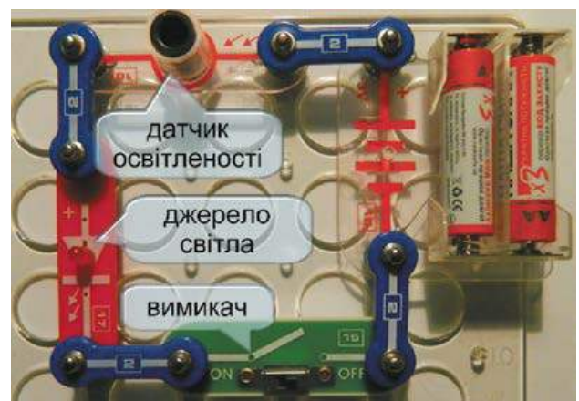
Мал. 8. Електричне коло з джерела струму, фотоопору, світлодіоду і вмикача (діючий макет)
