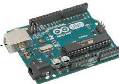
Мал. 10. Основна плата (апаратна частина) Arduino (під'єднується до USB порту ПК або використовується самостійно)
