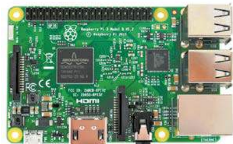
Мал. 19. Одна з реалізацій Raspberry Pi
