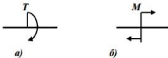
Рисунок 6 - Моменти сил: а) крутний, б) згинаючий
