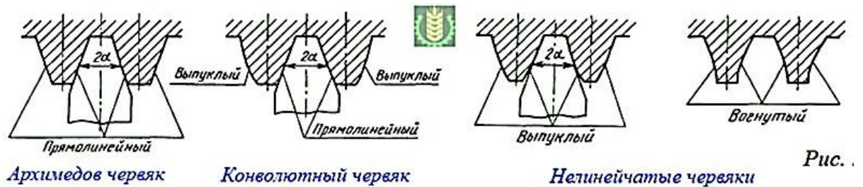
Рисунок 2 – Класифікація залежно від профілю гвинтової поверхні черв'яка
