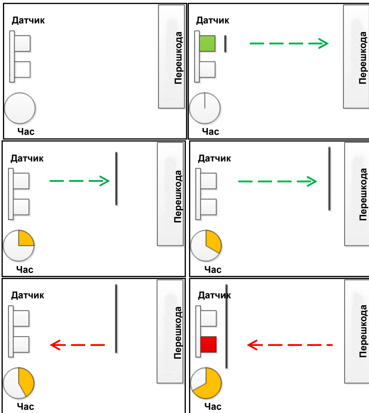
Рисунок 11.1 – Принцип роботи ультразвукового далекоміра
