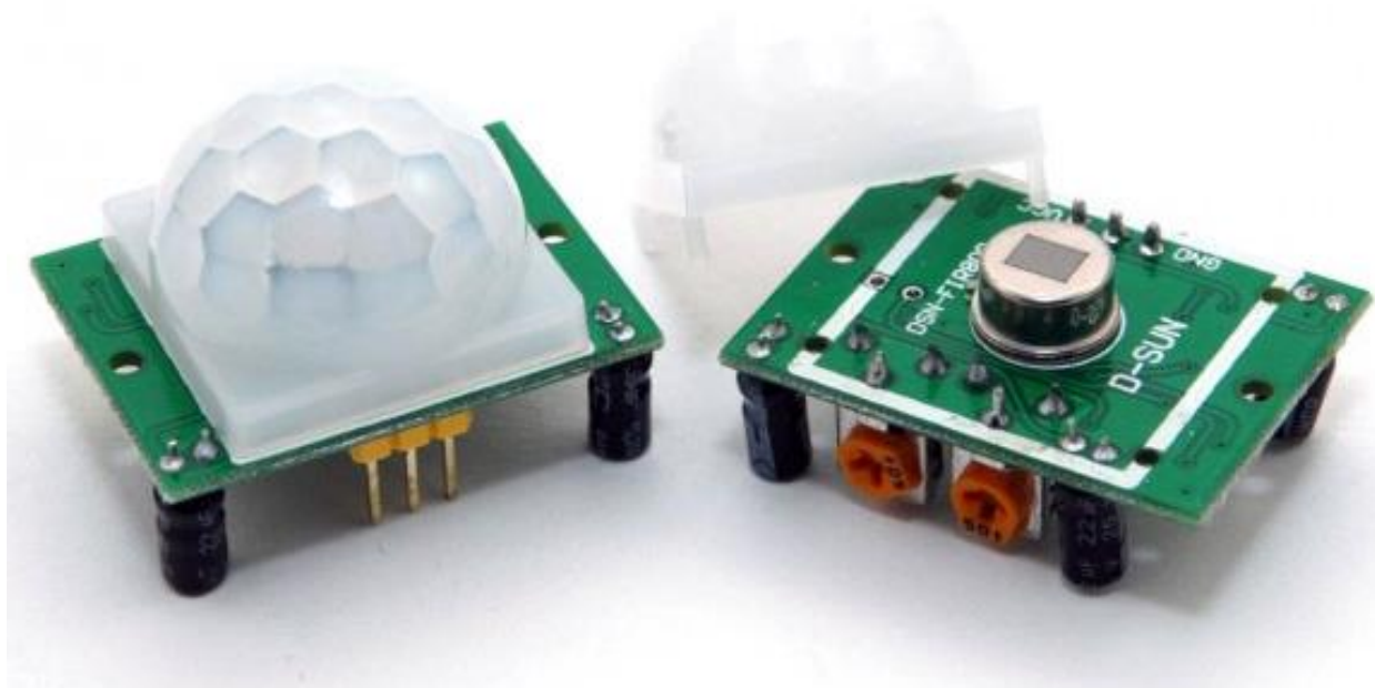
Рисунок 9.1 – Піроелектричний датчик руху HC-SR501
