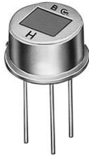
Рисунок 9.2 – Датчик температури IRA-E700 компанії Murata
