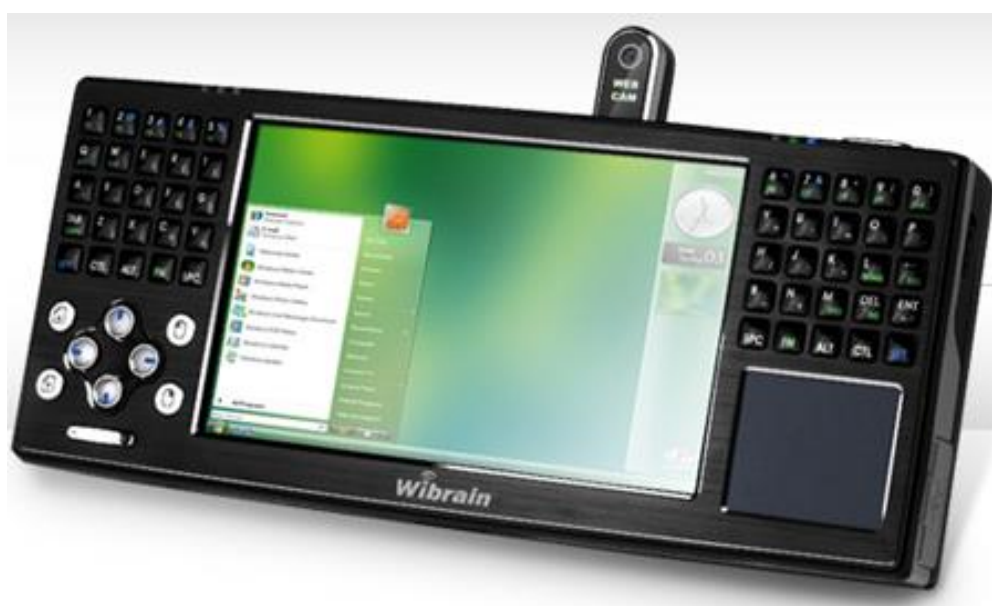
Рисунок 1.10 – Wibrain B1 UMPC на основі VIA Ultra Mobility Platform, з процесором 1.2 GHz VIA C7-M, 4.8" сенсорним екраном, клавіатурою, тачпадом і вебкамерою
