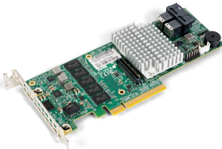
Рисунок 2.5 – RAID-контролер Supermicro AOC-S3108L-H8IR
