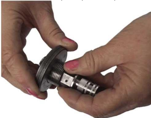
Рис.6.9.2.4. Контроль різьби непрохідними різьбовим кільцем
