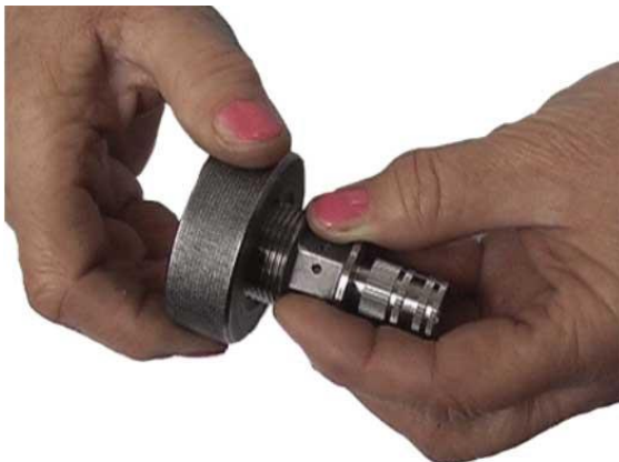
Рис.6.9.2.3. Контроль різьби прохідним різьбовим кільцем
