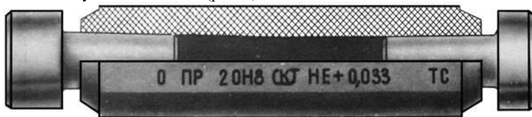
Рис. 4. Загальний вигляд та маркування двосторонньої повної калібр-пробки
