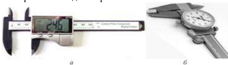
Рис. 5.6. Штангенциркуль цифровий (а), зі стрілочним індикатором (б)
