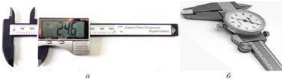
Рис. 5.6. Штангенциркуль цифровий (а), зі стрілочним індикатором (б)
