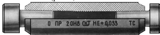
Рис. 4. Загальний вигляд та маркування двосторонньої повної калібр-пробки
