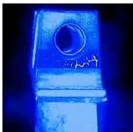
Рис. 5. Дефекти, виявлені люмінесцентним методом
