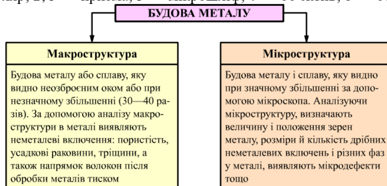
Рис. 7. Методи дослідження структури металів
