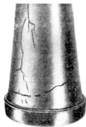
Рис. 2. Осад магнітного порошку на гартівних тріщинах у сталевій деталі, які не можна побачити оком
