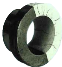
Рис. 3. Осад магнітної суспензії на виявлених дефектах
